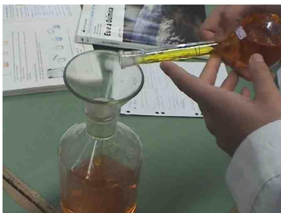
Figura 3.1 – Formas de transferência quantitativa de solução aquosa (a) usando o funil, (b) lavagem do resíduo da solução do béquer, (c) completando o volume, (d) agitação para homogeneização da solução do o balão volumétrico e (e) armazenagem em um frasco de vidro.
